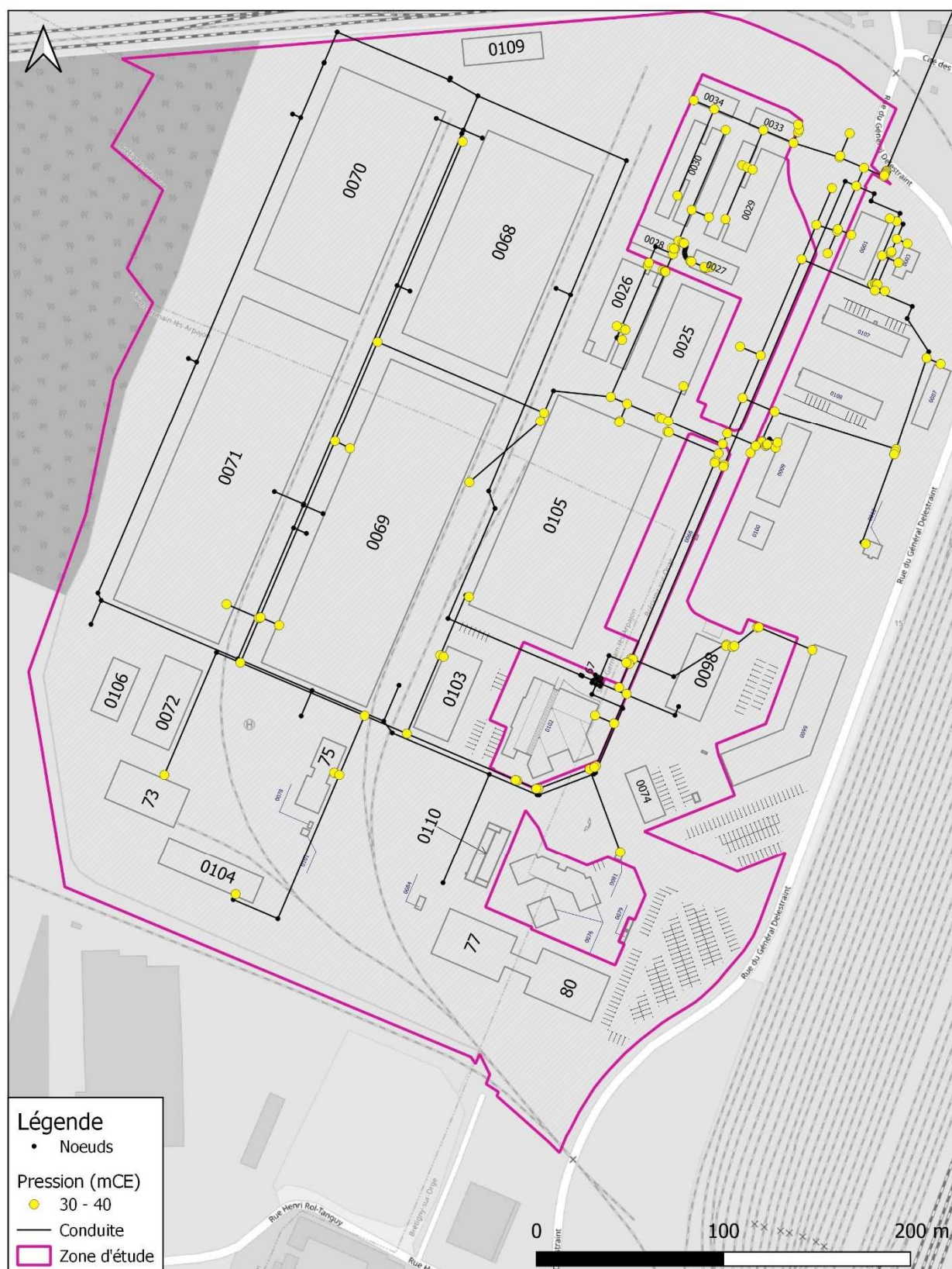
Figure 10 : Pressions maximales sur le réseau d'eau potable
